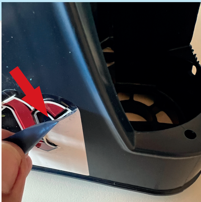
Kaschierfolie mit Druck löst sich (roter Pfeil) vom ursprünglichen Bedruckstoffmaterial der Etiketten.
